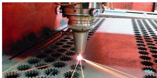
Установка лазерной резки Mitsubishi ML3015LVP дает возможность осуществлять лазерный раскрой и резку материалов.
